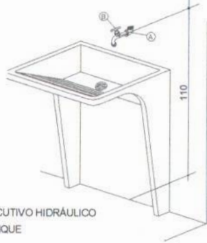
DETALHE EXECUTIVO HIDRÁULICO RAMAL DO LAVATÓRIO
