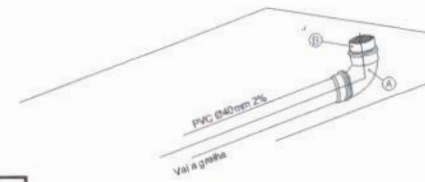
DETALHE EXECUTIVO DE ESGOTO RAMAL DRENO CENTRIFUGA
